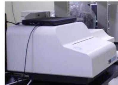
医学研究支援センターに設置しているPerkinElmer 社製ARVO X5 は、発光・蛍光強度・吸光度(紫外・可視)・時間分解蛍光・蛍光偏光測定を一台で行うことのできるマルチラベルプレートリーダーです。
